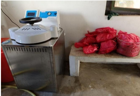
སྤྲོད་ཁང་ནང་འཛུགས་པའི་སྤྲོད་ཁང་གི་ ཉེན་ཁ་ཅན་གྱི་ཕྱགས་སྟེགས་ཚུ་ འཛུགས་ཀྱི་ འབད་ནི་གི་ Autoclaving འབྲེལ་ཆས།
